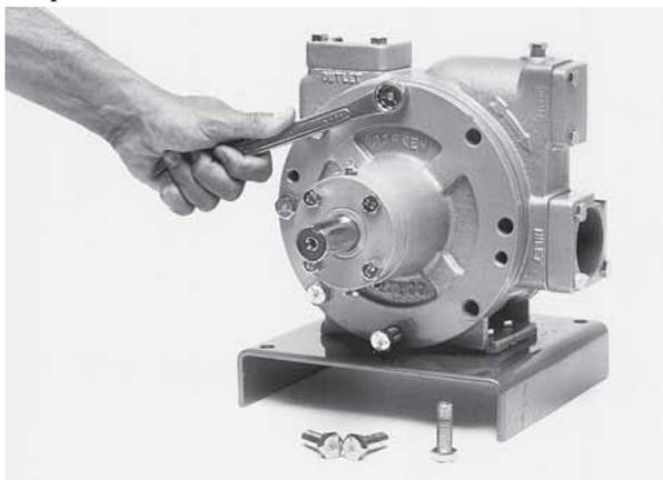
Затянуть болты головки по диагонали. Нет необходимости разбирать или повторно устанавливать шайбы на крышки подшипников. Повторить все вышеизложенные этапы при замене узла уплотнения на другой стороне.
