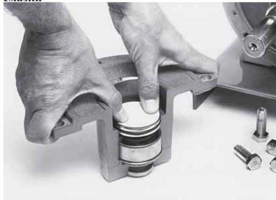
**ВНИМАНИЕ:** Вышеприведенная фотография сделана на разрезе для лучшей иллюстрации. Вывернуть го-ловку и установить новое уплотнение консистентной смазки, повернув его вниз и вдавливая его в просвер-ленное отверстие позади главного подшипника. Это лучше сделать с использованием старого седла уп-лотнения со снятым кольцевым уплотнением. Нанести обильное количество легкого смазочного масла на но-вое седло уплотнения. Используя защитный диск, осто-рожно вжать уплотнение на место.
