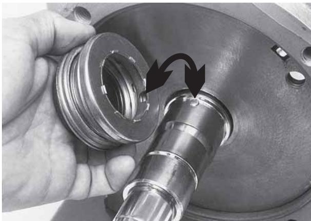
Очистить насос и нанести обильное количество легкого смазочного масла. Установить новый узел уплотнения, выровняв паз стопора уплотнения с приводным штифтом уплотнения на валу.
