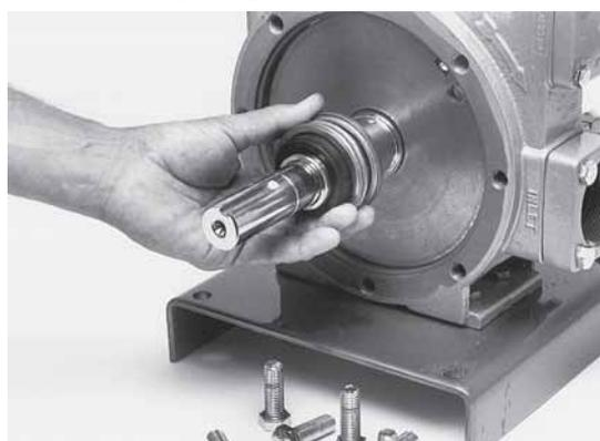
Извлечь узел старого уплотнения из вала насоса, при этом нажимая на рабочий диск насоса. Это позволит узлу стопора уплотнения быть извлеченным без вытя-гивания вала ротора из насоса.
