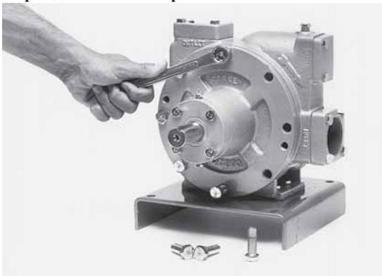
Ослабить болты головки и снять одну головку с прикре-пленной крышкой подшипника, при этом удерживая ее на валу.
