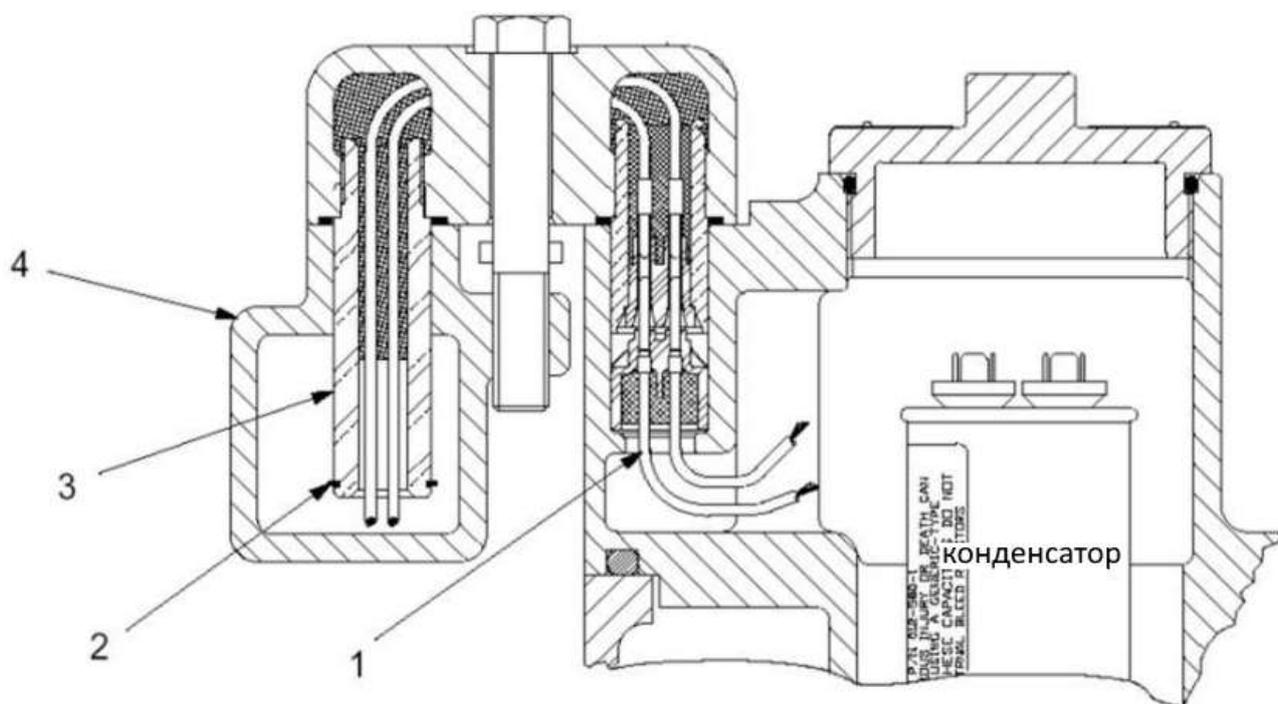
Рисунок 23: Идентификация деталей крестовины в сборе и распределительной коробки
