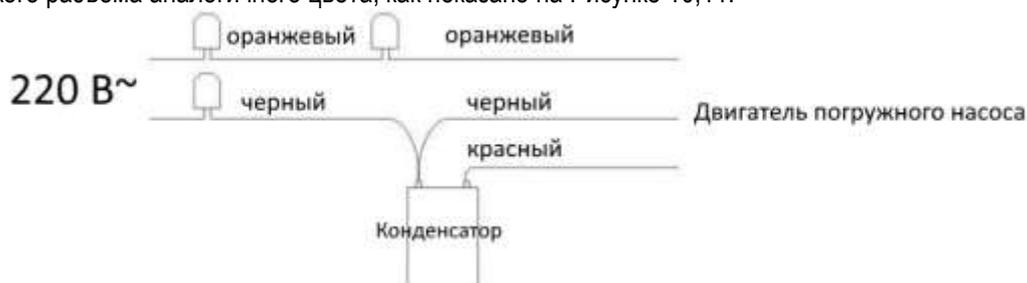
**Рисунок 10: Схема подключения конденсатора**
