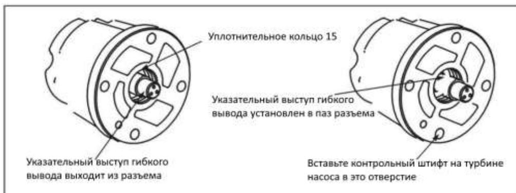
**Рисунок 5: Проверка правильности установки разъема гибкого вывода**
