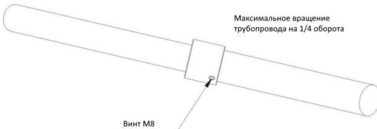
**Рисунок 7: Ослабление стопорной гайки**
