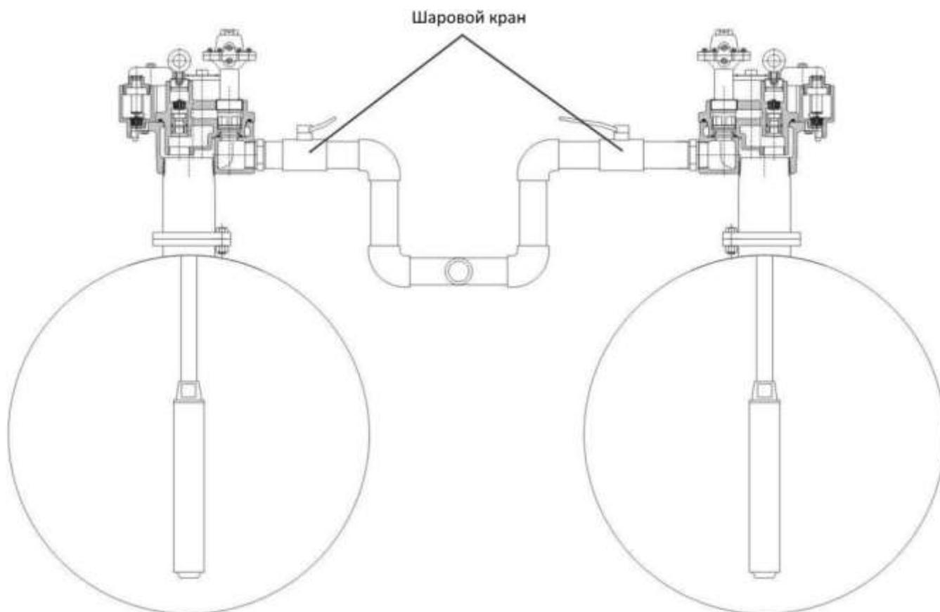
Рисунок 13: Параллельные насосы
