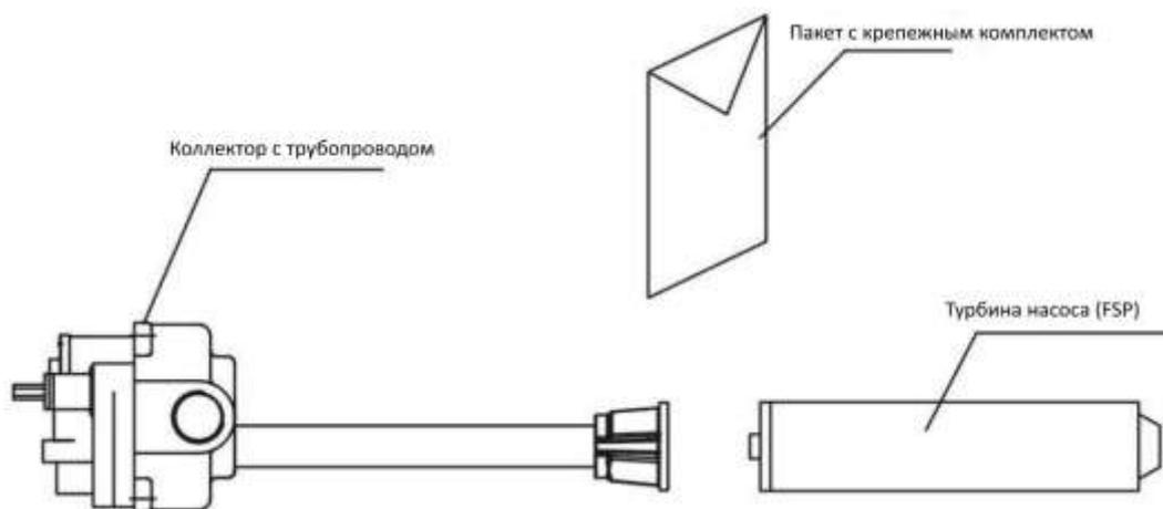
**Рисунок 3: Коллектор с трубопроводом, прикрепленным к ИПТ**
