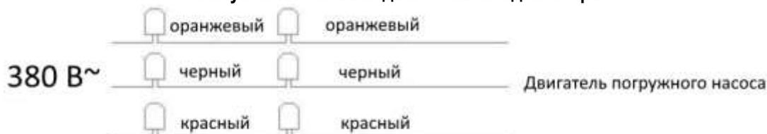
**Рисунок 11: Схема подключения**
