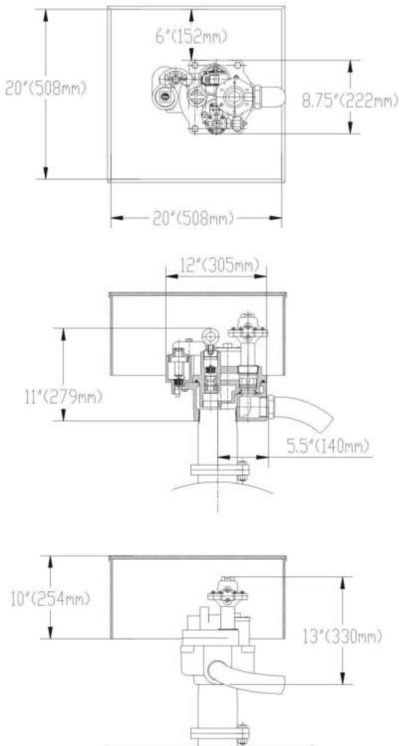
Рисунок 1: Размеры датчика утечки и коллектора
