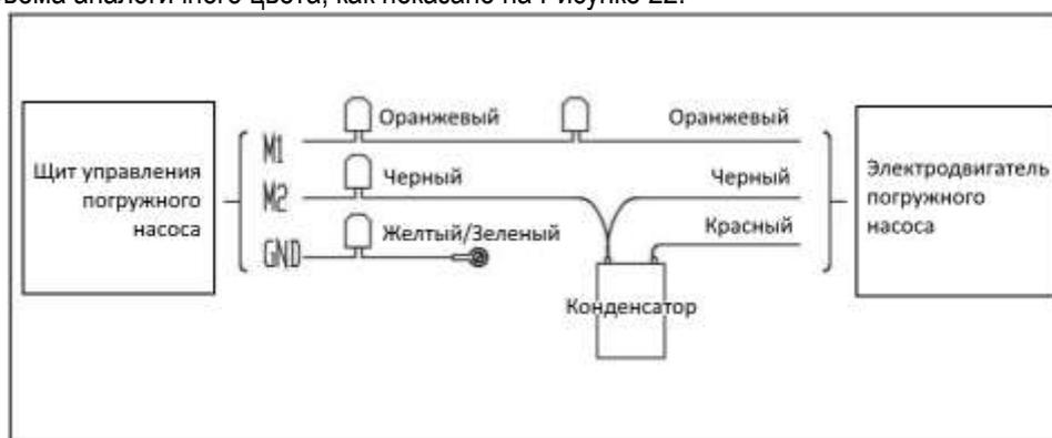
Рисунок 22: Схема проводки
