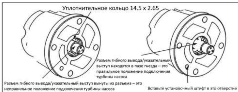
**Рисунок 20: Убедитесь, что разъем гибкого вывода установлен правильно**
