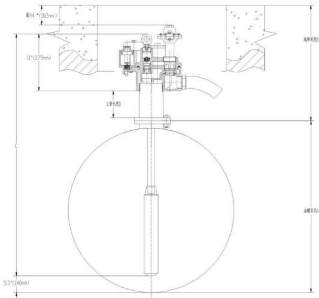
Рисунок 2: Измерение резервуара (диапазоны регулировки см. в Таблице 2).
